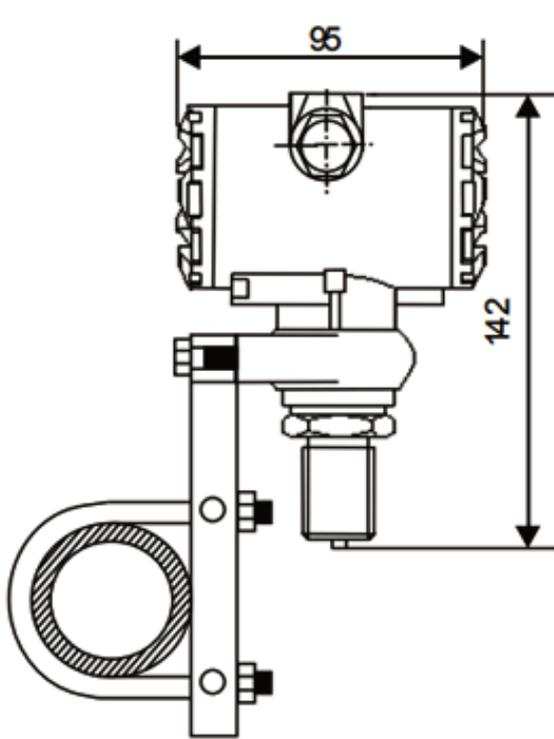
扩散硅压力变送器水平管道安装
