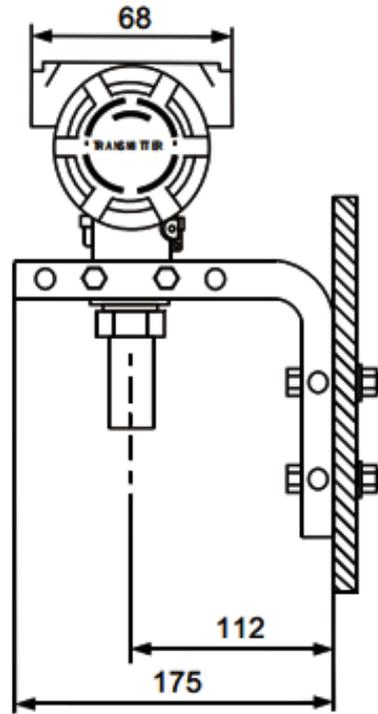
扩散硅压力变送器面板安装
