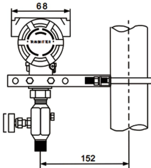
扩散硅压力变送器垂直管道安装
